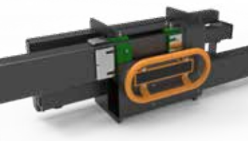
Välilevyt ruostumatonta terästä, paksuudet 0,5 mm ja 0,7, minimoi muoviosan ja varren väläksen.
